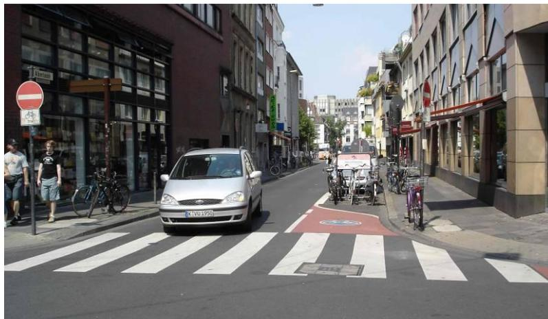
Fotografía 13. Dispositivo que facilita el acceso a una calle a contracorriente en Alemania.
