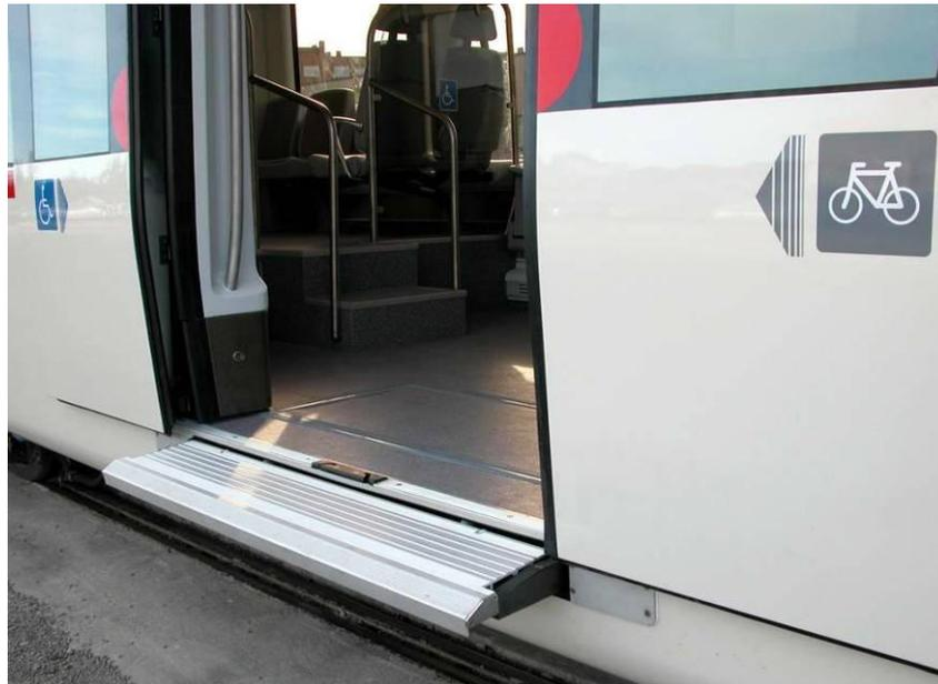
Ilustración 13. Acceso para sillas de ruedas y bicicletas del coche intermedio de piso bajo de los trenes CIVIA de cercanías (Fuente: RENFE).
