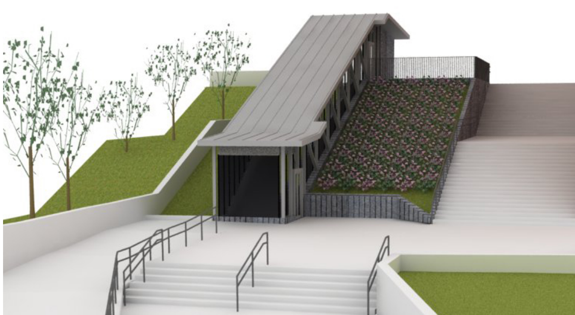
Imagen 2. Infografía de propuesta de elevador inclinado
